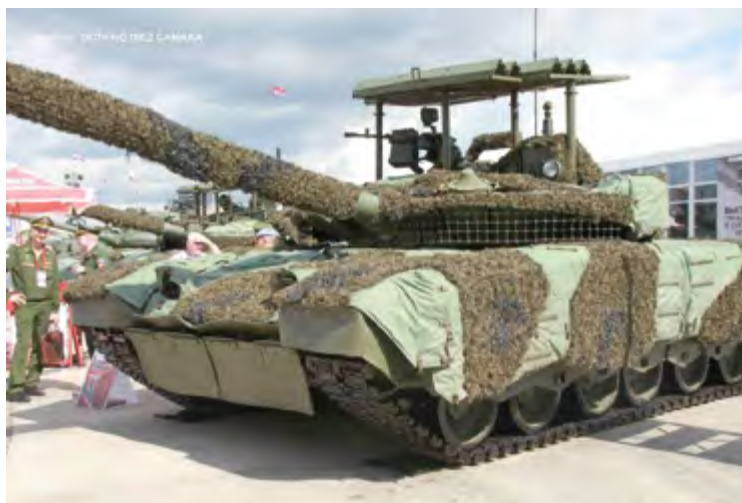
Carro ruso T-80 con jaula antidrón (fuente: Octavio Díez Cámara)
