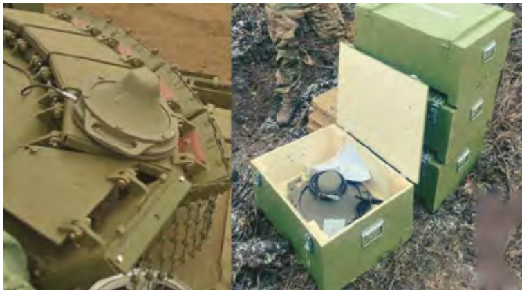
Inhibidores contra UAS instalados en carros rusos (fuente: armadainternational.com)
